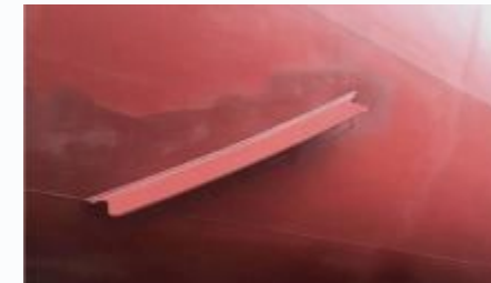
HULL FIN - 선체 저항 감소 및 개선
