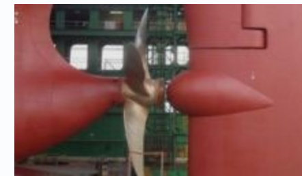
RUDDER BULB+ DIVERGENT PROPELLER CAP - 프로펠러 추진 효율 개선
