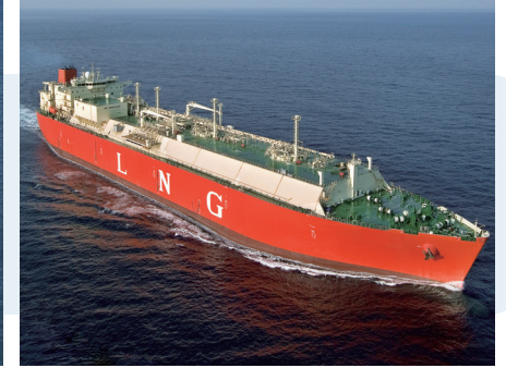
STX KOLT, 153,000m³ LNG선
